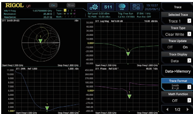
VNA模式可以实现对元器件、电路网络的S11、S21以及故障点定位的测量，通过史密斯圆图、极坐标等多种显示更精确地表征被测件的网路特性
