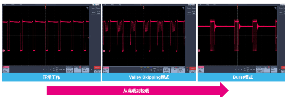
从满载到轻载的电源模块输出波形
