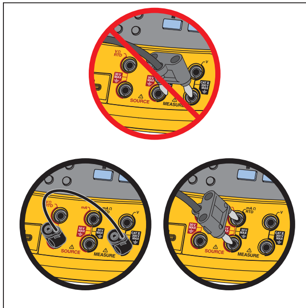
图 16. 正确的跨接器使用
