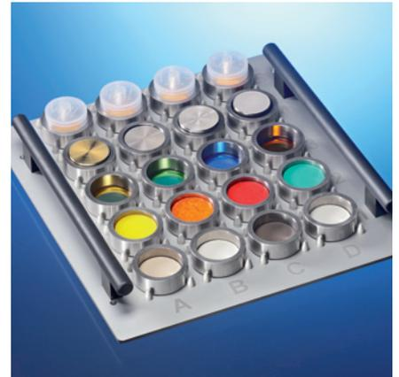
装载 20 个样品的 EasyLoad (便捷进样) 托盘
