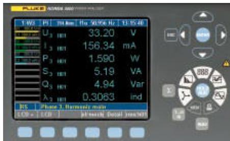
利用箭头键，用户可改变相，或者移动光标来突出显示相应的区域，仅需按下 ENTER 键即可。可以方便地根据应用修改设置。还可以保存最常用的配置，以供随后使用。
