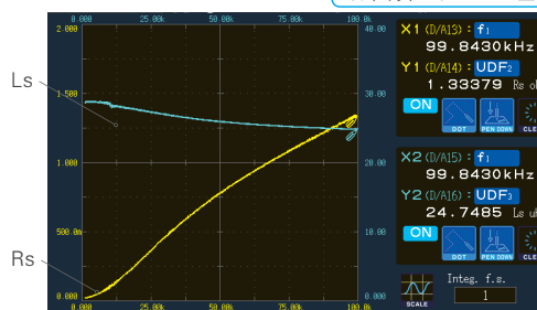
电抗的阻抗 - 频率特性的 X-Y 绘图
